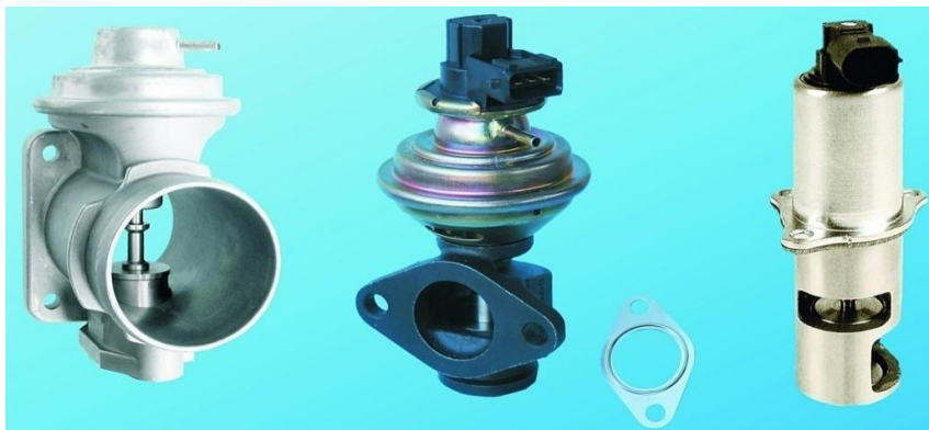
Rys. 14 Od lewej, pneumatyczny zawór EGR, pneumatyczny zawór EGR z rozpoznaniem położenia, elektryczny zawór EGR dwudrogowy [5]
