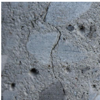
Rys. 6.11. Przykłady rozwoju rys w betonie z kruszywem granitowym
