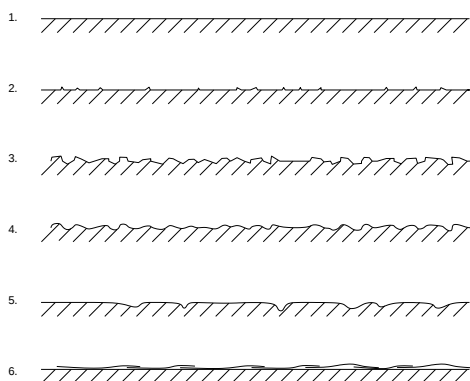
Rys. 6.6. Typy tekstury powierzchni ziaren kruszywa (numery wg tab. 6.2)
