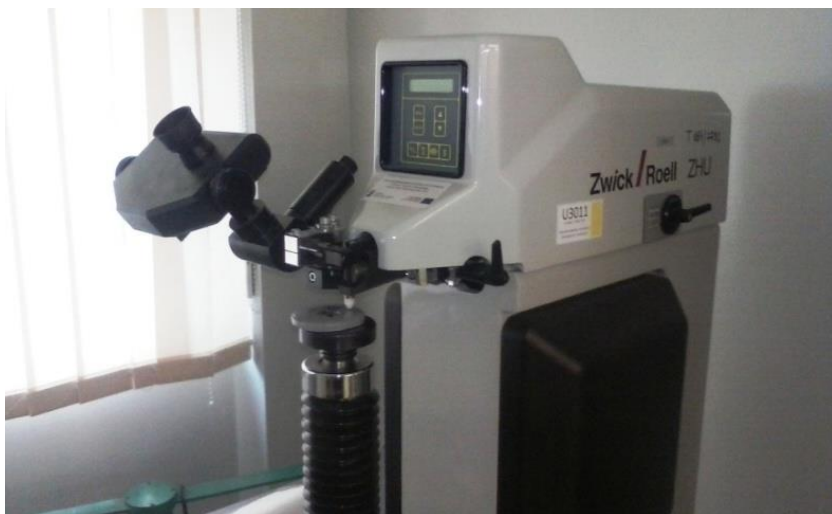
Rys. 8.11. Twardościomierz użyty w badaniach
