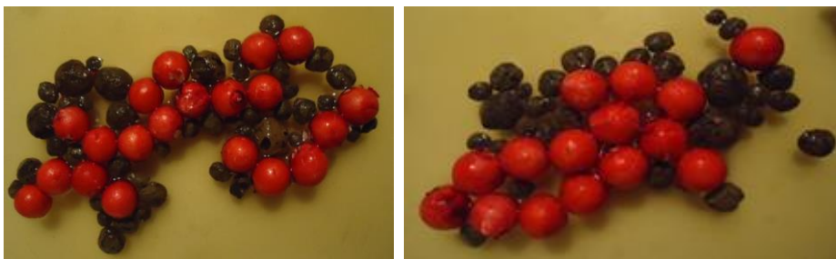
Rys. 4.33. Przykłady organizacji agregatów mieszanych: ziarna keramzytu i granulki styropianu na powierzchni cieczy WS (woda+superplastifikator)
