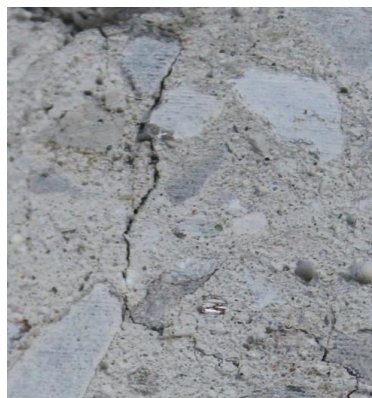
Rys. 6.11. Przykłady rozwoju rys w betonie z kruszywem granitowym
