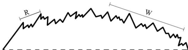
Rys. 6.1. Falistość i chropowość R powierzchni
