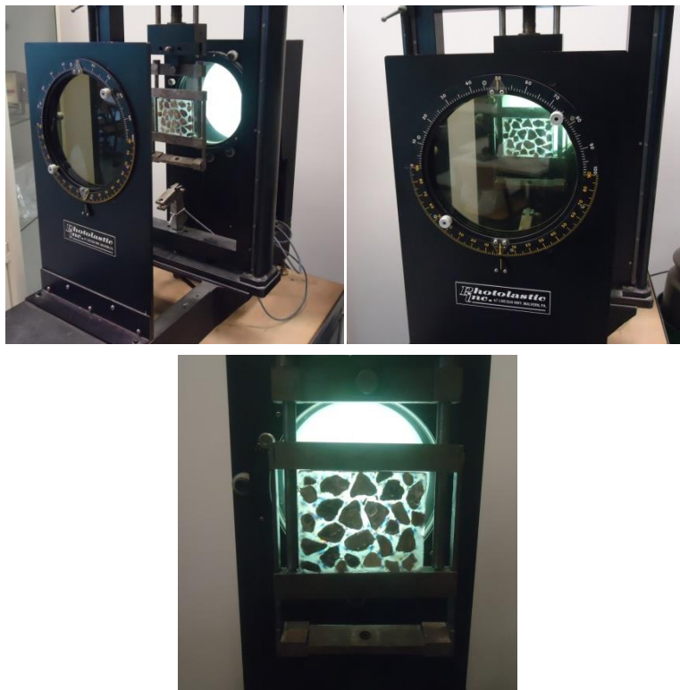
Rys. 5.18. Widok polaryskopu z umieszczoną próbką
