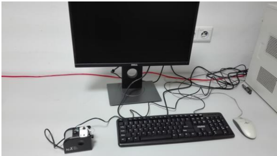
Rys. 6.14. Stanowisko do badania chropowatości powierzchniowej
