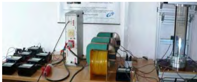
Rys.1. Układ pomiaru zaburzeń przewodzonych reaktora plazmowego typu GlidArc
