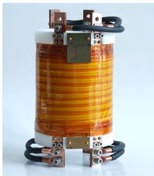
Rys. 1. Nadprzewodnikowy ogranicznik prądu z uzwojeniami wykonanymi z taśmy drugiej generacji SuperPower SF12050
