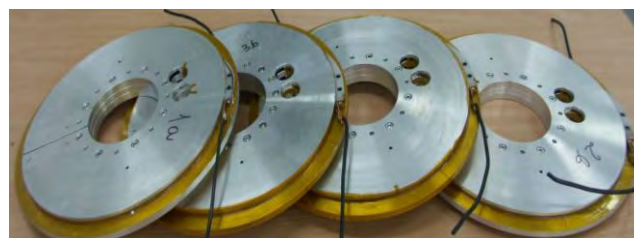
Rys.1. Cewki podwójne z nadprzewodnika B-2223 dla modelu SMES'a o konstrukcji cewkowo-toroidalnej.
