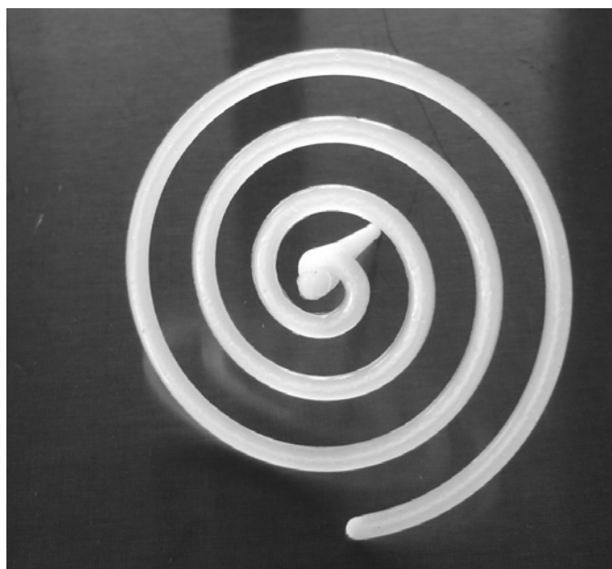
Rys. 9.2. Wygląd wypraski wtryskowej z tworzywa termoplastycznego w kształcie spirali (tzw. spirala Archimedesesa)
