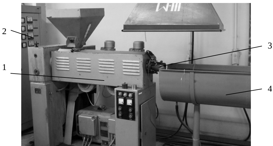
Rys. 4.1. Wygląd ogólny linii technologicznej wytłaczania porującego: 1 - wytłaczarka T32-25, 2 - szafa sterownicza, 3 - głowica wytłaczarska do prętów, 4 - urządzenie ochładzające
