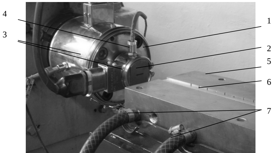
Rys. 2.4. Głowica wytłaczarska do kształtownika wraz z widoczną częścią dolną kalibratora: 1 - korpus głowicy wytłaczarskiej, 2 - korpus dyszy głowicy, 3 - grzejnik pierścieniowy, 4 - czujnik temperatury, 5 - kalibrator, część dolna, 6 - wkładka formująca dolna 7 - węże doprowadzające wodę ochładzającą
