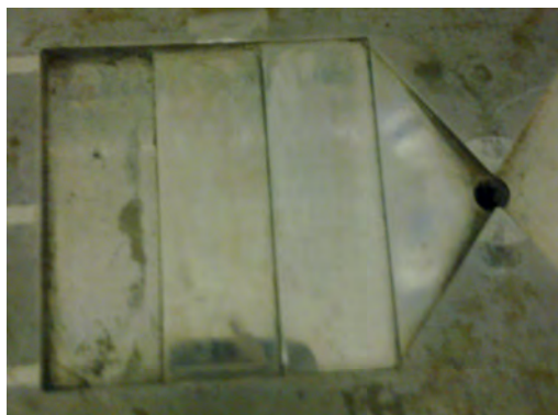
Rys. 3. Wygląd przykładowego gniazda formującego formy wtryskowej w metodzie gniazda schodkowego
