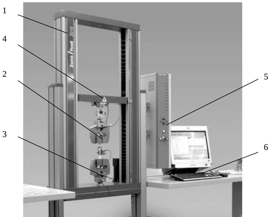
Rys. 7. 5. Wygląd maszyny wytrzymałościowej wraz z oprzyrządowaniem podczas statycznego rozciągania tworzyw: 1 - rama stalowa, 2 - uchwyt górny, 3 - uchwyt dolny, 4 - ruchoma poprzeczka, 5 - zespół sterowniczy, 6 - stanowisko komputerowe
