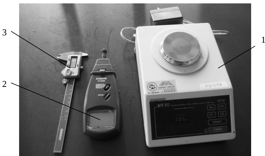
Rys. 4.3. Wygląd urządzeń pomocniczych stosowanych podczas badań procesu wytłaczania porującego tworzyw: 1 - waga laboratoryjna WPE 60, 2 - tachometr DT-6236B, 3 - suwmiarka Orion EH807557
