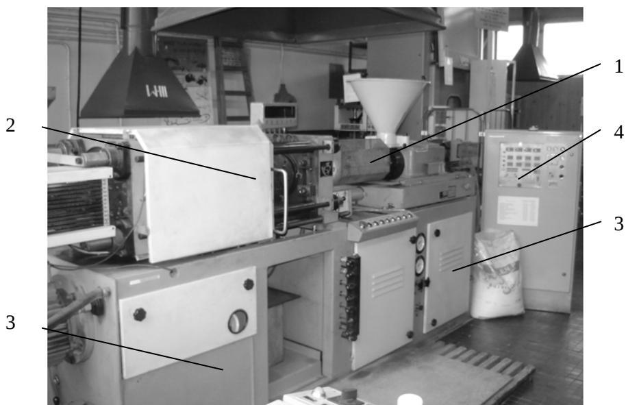
Rys. 10.1. Wygląd wtryskarki ślimakowej CS 88/63 wraz z szafą sterowniczą: 1 - układ uplastyczniający (obudowa), 2 - układ narzędziowy, 3 - układ napędowy, 4 - szafa sterownicza
