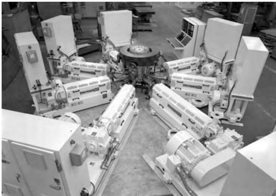
Rys. 18. Wygląd stanowiska technologicznego do współwytłaczania z rozdmuchiwanym swobodnym folii siedmiowarstwowej (Davis-Standard LLC, USA)
