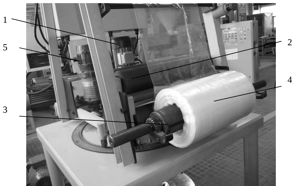
Rys. 8.4. Urządzenie odbierające i urządzenie nawijające linii technologicznej wytłaczania z rozdmuchiwaniem: 1 - silnik elektryczny urządzenia odbierającego, 2 - walec napędzany urządzenia odbierającego, 3 - szpula nawijająca urządzenia nawijającego, 4 - wytworzona folia, 5 - silnik elektryczny ruchu obrotowego ramy odciągowej
