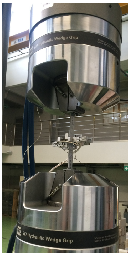
Ryc. 6.1. Stanowisko laboratoryjne i próbki stosowane do określania charakterystyk wytrzymałościowych stali
