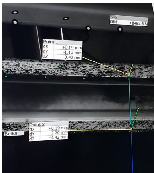
Ryc. 4.5. Prezentacja z pomiaru przemieszczenia w oprogramowaniu GOM Correlate
