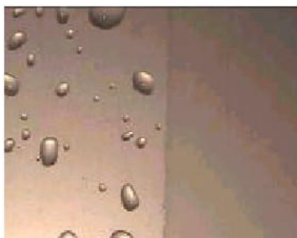
Rys. 4.9. Przykład powierzchni przed koronowaniem (lewa strona) i po koronowaniu (prawa strona) [308]
