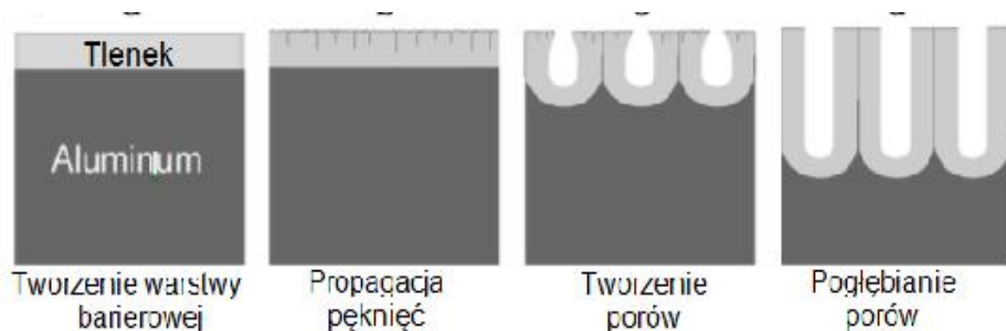
Rys. 4.6. Etapy narastania warstewki tlenkowej podczas anodowania aluminium [105]
