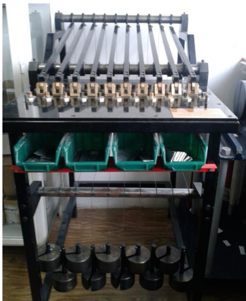
Rys. 2.4. Stanowisko laboratoryjne do wykonywania połączeń klejowych
