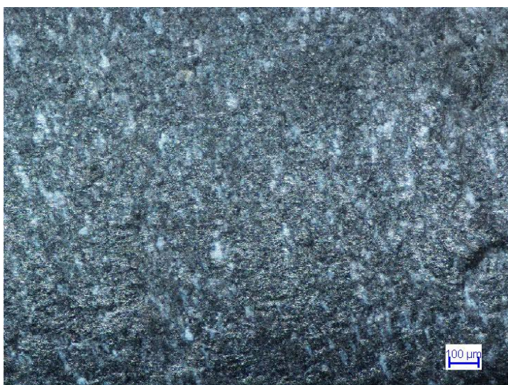
Rys. 5. Morfologia struktury próbek polipropylenu PPH 60B [opracowanie własne]
