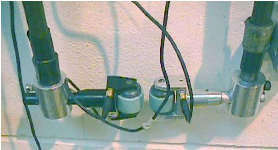
Rys. 16. Wygląd układu rolkowych głowic ultradźwiękowych wykorzystywanych do badań metodą echo w laboratorium NDT zakładów lotniczych, PZL Świdnik S.A [7]
