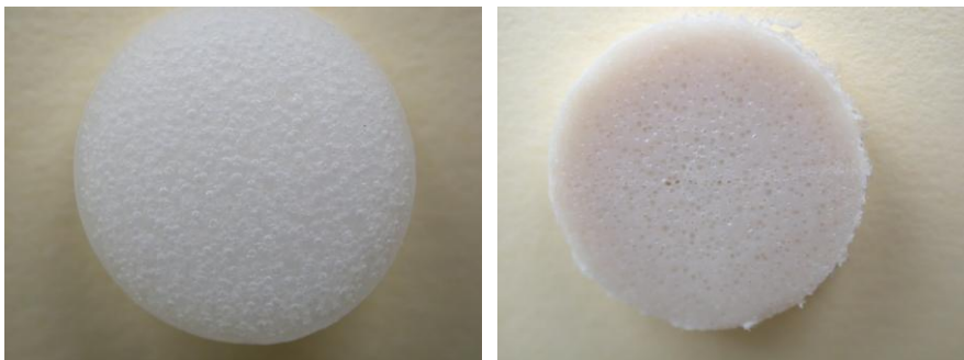
Rys. 3. Przykłady wytworów uzyskanych za pomocą porowania do wewnątrz, przekrój poprzeczny pręta z PE-HD oraz PVC twardego [opracowanie własne]
