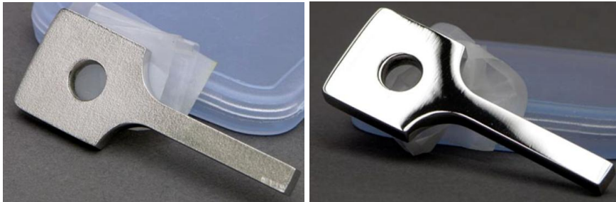
Rys. 8. Przedmiot wykonany metodą SLM: a) bezpośrednio po procesie wytwarzania, b) po obróbce wykańczającej (polerowanie) [10]
