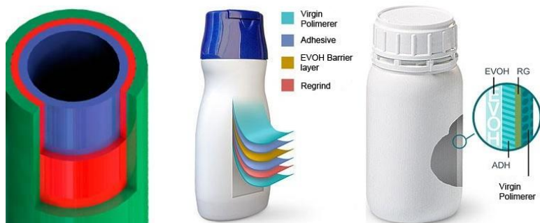
Rys. 1. Przykład wytworów współwytłaczanych: a) rura trójwarstwowa (Biomerics USA), b) pojemnik wielowarstwowy (Alcion Plasticos, Hiszpania)
