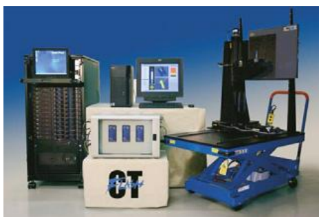
Rys. 4. Wygląd przenośny rentgenowskiego tomografu firmy Haytec Inc oraz przykład obrazu cieniowego [5]
