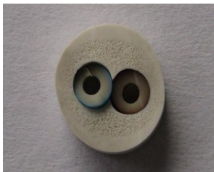
Rys. 7. Powłoki kabla elektrycznego otrzymane w procesie współwytłaczania porującego [opracowanie własne]
