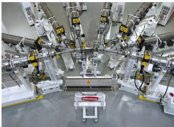
Rys. 4. Przykład wielotworzywowego (taśma ośmio-warstwowa) współwylączania taśmy (Welex, USA)
