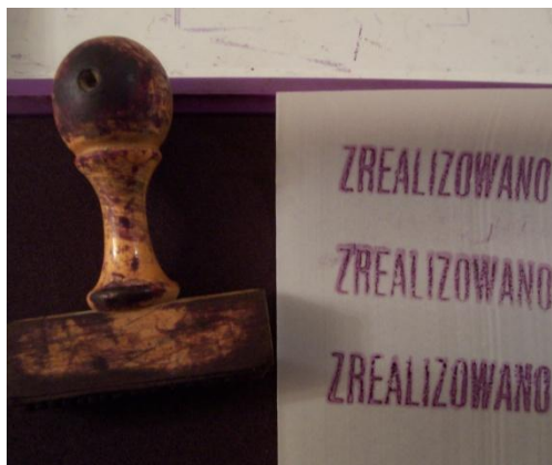
Rys. 10. Możliwość znakowania folii papieropodobnych za pomocą a) pieczętki typu stempel, b) ołówka, długopisu oraz pieczętki automatycznej [opracowanie własne]
