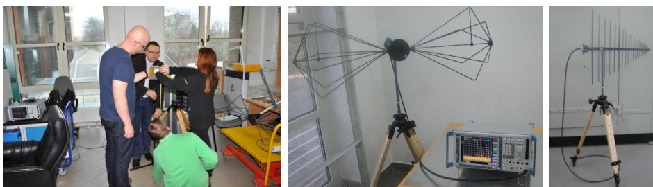
Rys. 5. Zdjęcia z badań emisji reaktorów, oraz zdjęcia użytej aparatury pomiarowej
