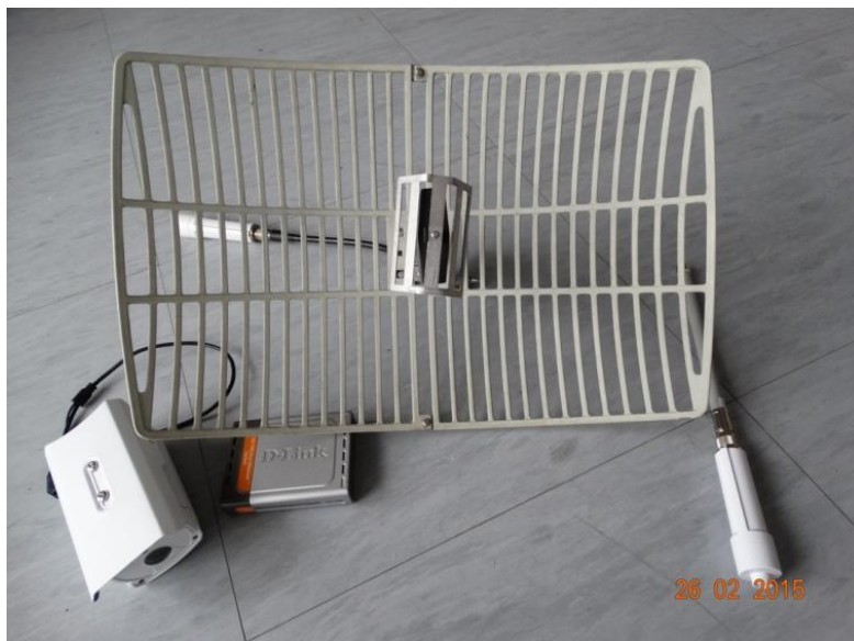
Rys. 3. Urządzenia sieciowe wykorzystane w projekcie. Od lewej: kamera IP, switch, router z anteną kierunkową, router z anteną dookólną. (źródło: opracowanie własne)
