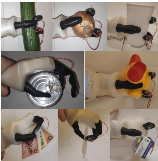
Rys. 12. Chwyty wykonywane podczas przeprowadzania testów
