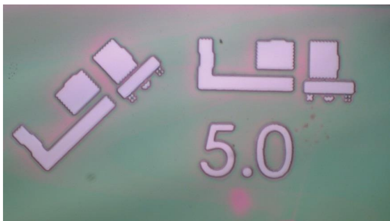
Rys. 7. Widok kształtu 5 µm na płytce PT_1
