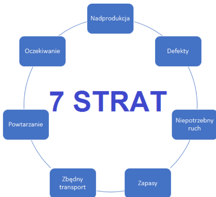
Rys. 2. Eliminacja marnotrawstwa zgodnie z zasadą 7 rodzajów strat [5]
