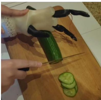
Rys. 11. Użycie wyprofilowanej powierzchni bocznej do przytrzymywania przedmiotów podczas czynności dnia codziennego
