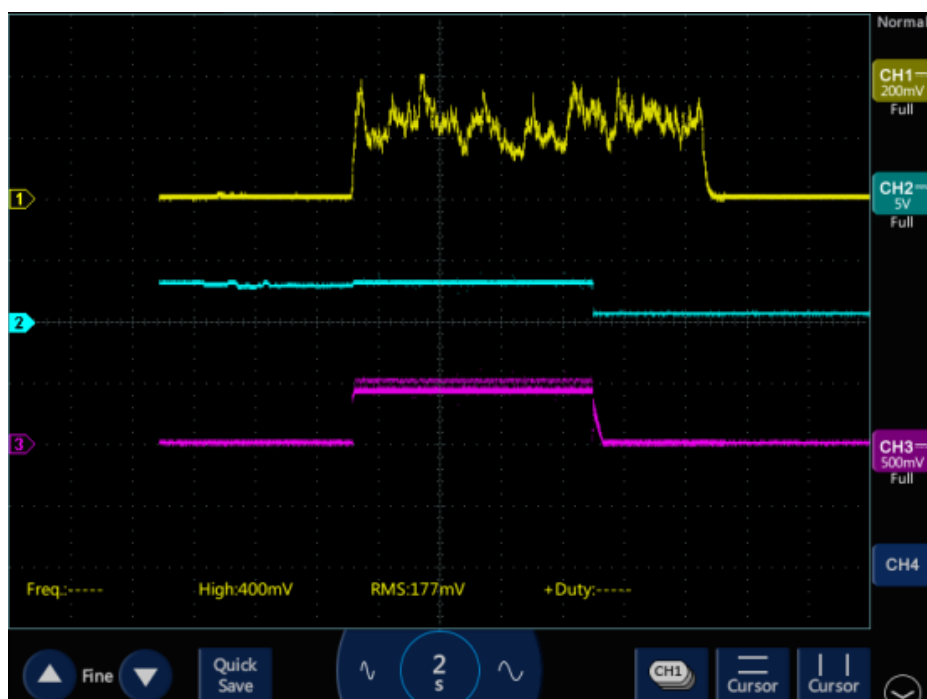
Rys. 10. Oscylogram zależności sygnału na wyjściu czujnika EMG (kolor żółty), zabezpieczeń krańcowych (kolor niebieski) oraz napięcia na zaciskach silnika (kolor fioletowy) w dziedzinie czasu
