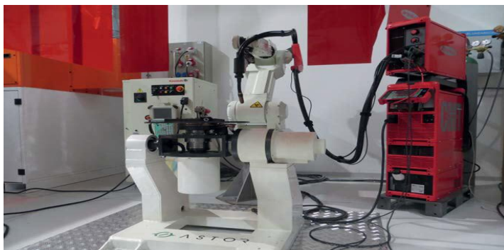
Rys. 7 Robot Kawasaki FA006E z pozycjonerem dwuosiowym wykorzystywany w technologii zrobotyzowanego spawania [12]
