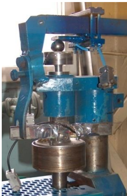
Rys. 6.2. Widok głowicy badawczej zmodernizowanego tribotestera
