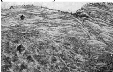
Rys. 4.24. Mikrostruktura powierzchni tarcia w przekroju próbki po badaniu w warunkach adhezji pierwszego rodzaju
